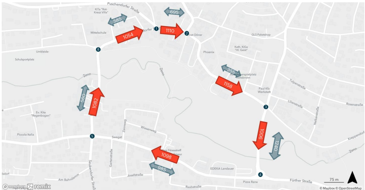
Abbildung 38: Abschätzung der Verkehrsmengen im Prognosefall Einrichtungsverkehr im Uhrzeigersinn
