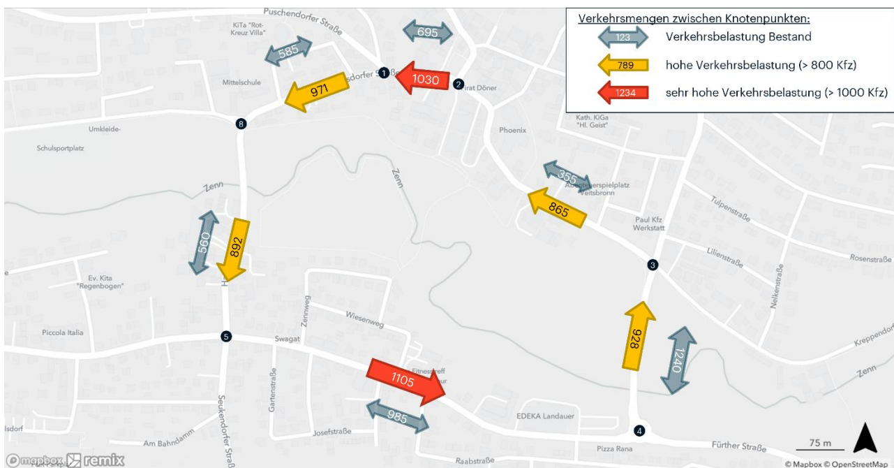
Abbildung 37: Abschätzung der Verkehrsmengen im Prognosefall Einrichtungsverkehr entgegen Uhrzeigersinn
